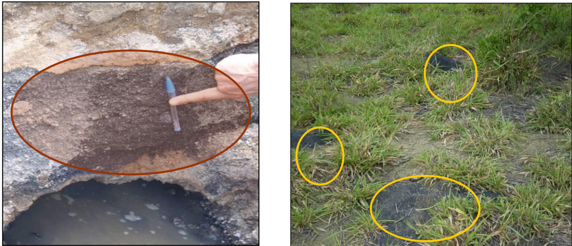
Figura 2.3 - Escória aterrada nas Ruas e espalhada na área entorno da antiga fábrica
